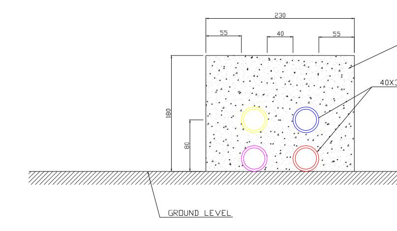
TYPICAL TELECOM DUCT GROUND LAYING
